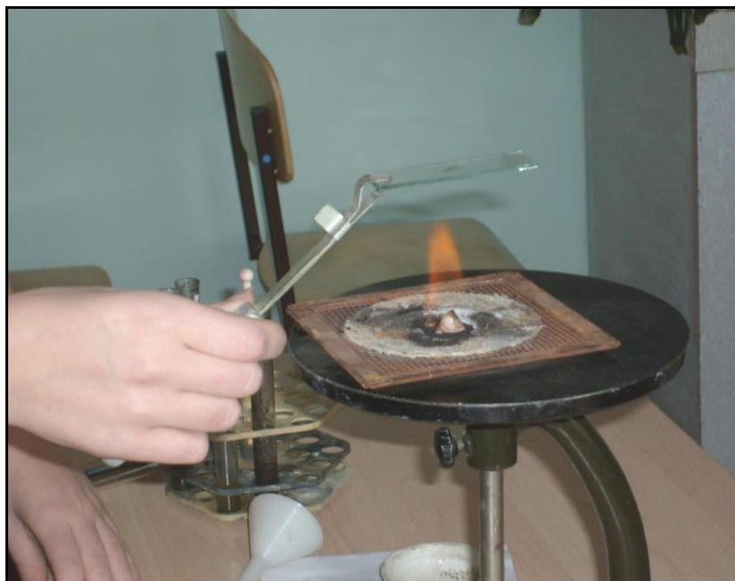
Процесс выпаривания воды из почвенной вытяжки
